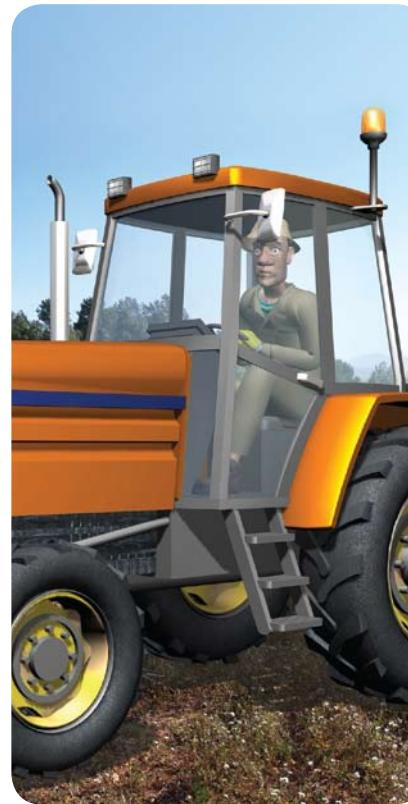
Per evitar atrapades per bolcada de tractor, cal disposar d'una estructura antibolcada com la cabina o l'arc antibolcada
