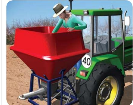
*Ne manipulez pas et ne répandez pas à la main le fertilisant compacté à l'intérieur de la trémie sans avoir préalablement déconnecté sa prise de force*
