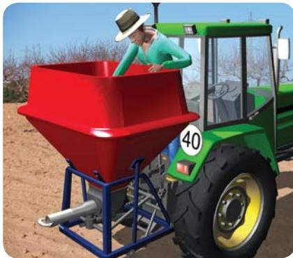
يجب عدم التلاعُب أو تقليل الطوب المحشور داخل قمع التلقيم بواسطة اليد قبل إطفاء الماكنة
