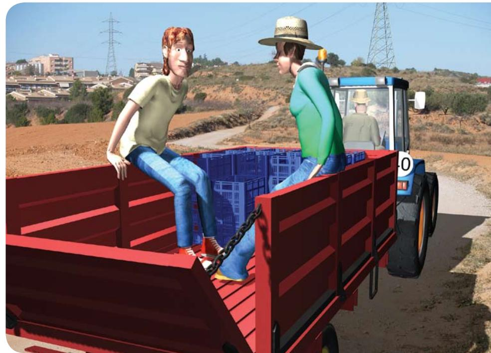
No utilitzeu el remolc per al transport de persones si no disposa d'un seient específic
