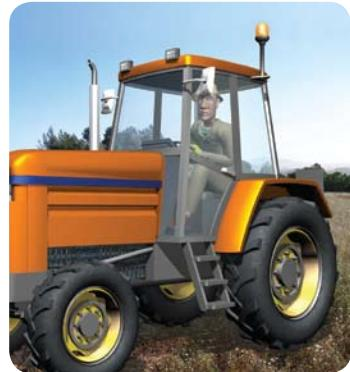
Para evitar cogidas por vuelco de tractor, debe disponerse de una estructura antivuelco como la cabina o el arco antivuelco
